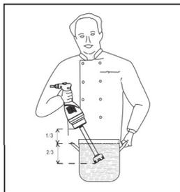
Garanta sempre que a campânula está suficientemente imersa para evitar salpicos e que a circulação do ar do motor não entre em contacto com qualquer líquido.
