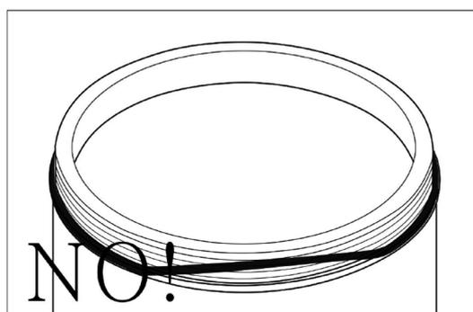
A junta deve estar corretamente colocada. A colocação incorreta da junta irá provocar derramamento de líquidos.
