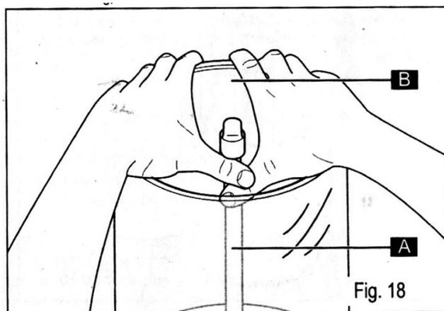
Liberte a cuba do corpo da máquina, usando dois dedos para o afastar da parte de metal fixa do misturador.
