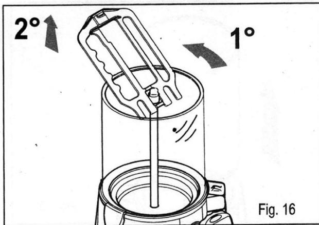
Incline o mexedor e puxe-o para cima conforme mostra a figura para o remover completamente.
