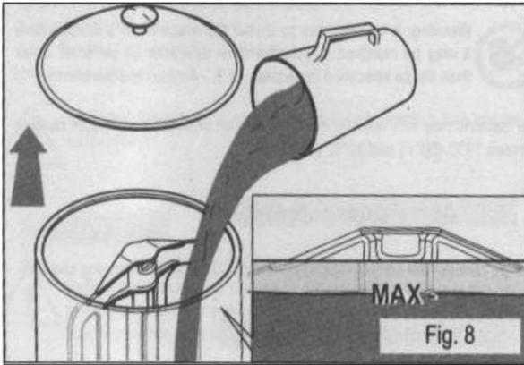
Remova a tampa e despeje a bebida preparada segundo as instruções do fabricante na cuba. Nunca exceda o nível máximo marcado (MAX:)
